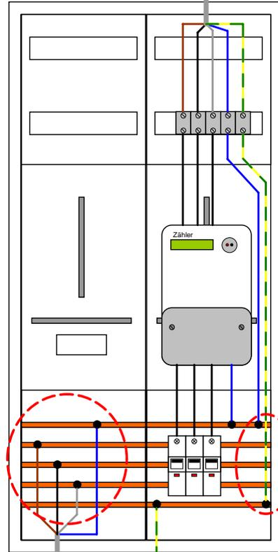
Auf den blanken Stromschienen sind zum Einhalten der doppelten Isolierung, Isolierstreifen/Isolierclips anzubringen.
