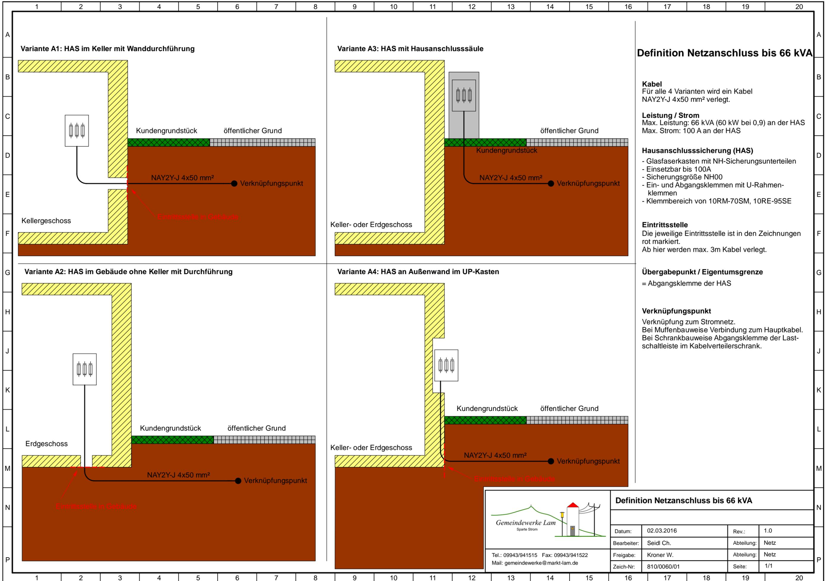
**Definition Netzanschluss bis 66 kVA**
