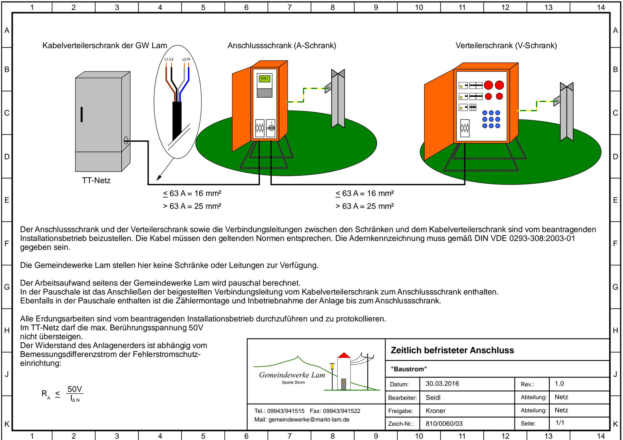
Der Anschlusschrank und der Verteilerschrank sowie die Verbindungsleitungen zwischen den Schränken und dem Kabelverteilerschrank sind vom beantragenden Installationsbetrieb beizustellen. Die Kabel müssen den geltenden Normen entsprechen. Die Adernkennzeichnung muss gemäß DIN VDE 0293-308:2003-01 gegeben sein.
